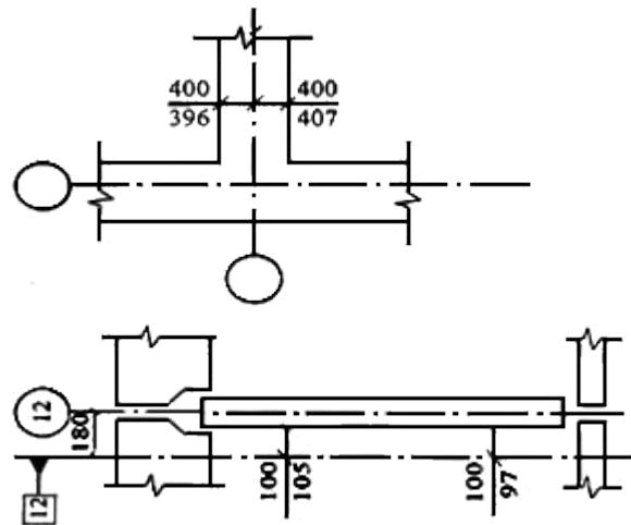
а - от граней монолитного ростверка до разбиваемой в натуре координационной оси; б - от граней стеновой панели до разбиваемой в натуре параллели оси
