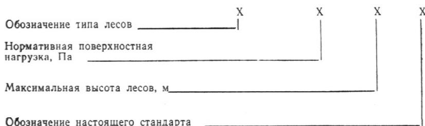
Пример условного обозначения лесов стоечных приставных хомутовых с нормативным значением поверхностной нагрузки 2000 Па и максимальной высотой 60 м:
