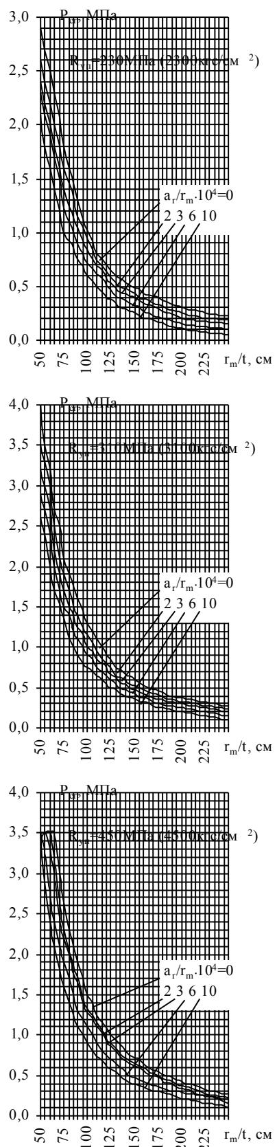
Черт. 2. График зависимости критического наружного давления  $\rho_{cr}$  от относительной толщины стенки  $r_m/t$  [ $R_{yn}$  – нормативное сопротивление по пределу текучести стали, МПа ( $\text{kgs}/\text{cm}^2$ );  $a_r$  – расчетный радиальный зазор между стенкой оболочки и бетоном, см;  $r_m$  – средний радиус оболочки, см;  $t$  – толщина стенки оболочки, см]
