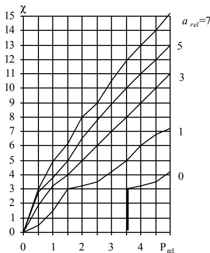
Черт. 3. График зависимости коэффициента  $\chi$  от  $p_{rel}$  при  $a_{rel} = \text{const}$
