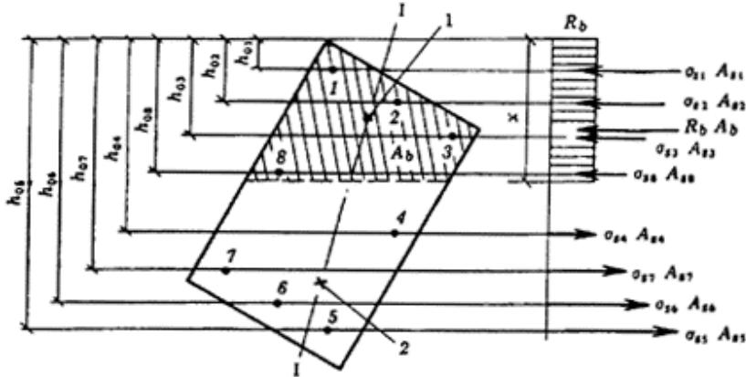
Черт. 1. Схема усилий и эпюра напряжений в сечении, нормальному к продольной оси железобетонного элемента, при расчете его по прочности
