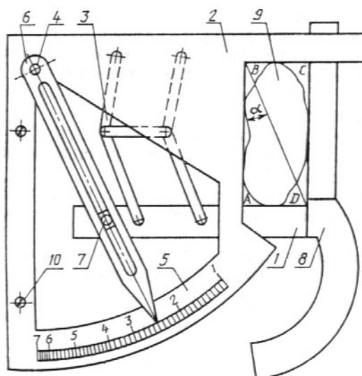
1 — подвижный угольник; 2 — неподвижный угольник; 3 — двойной шарнирный параллелограмм; 4 — кулиса-стрелка; 5 — шкала; 6 — ось поворота; 7 — ось ползуна;
