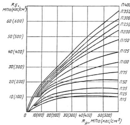
$R_b$  — прочность бетона;  $R_p$  — прочность раствора, отсевенного от бетона;
