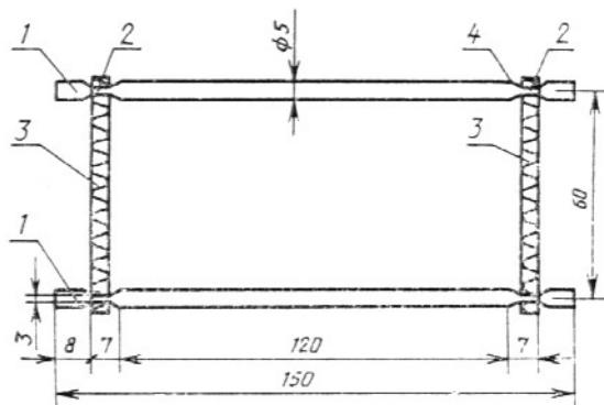
1 — металлические стержни диаметром 5 мм; 2 — места расточки стержней до диаметра 3 мм; 3 — резинка-продержка (или стальная пружина);
