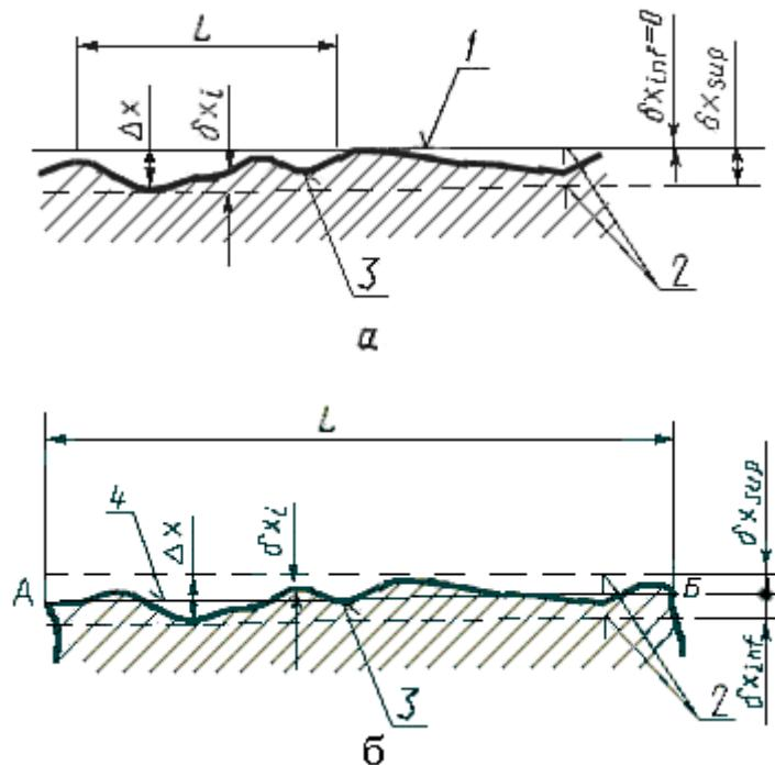
а - допуск и отклонение от прямолинейности при измерениях на заданной длине;
