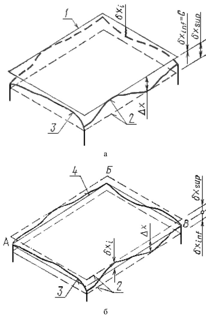
а - допуск плоскостности и отклонение от плоскости при измерениях от прилегающей плоскости; б - то же, при измерениях от условной плоскости, проходящей через три крайние точки реальной поверхности;
